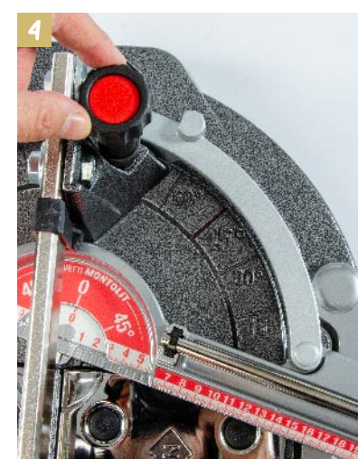
4, 5. Svitando la manopola si libera la rotazione della squadra di misura che normalmente ruota e può essere impostata fra 0° e 75°.
