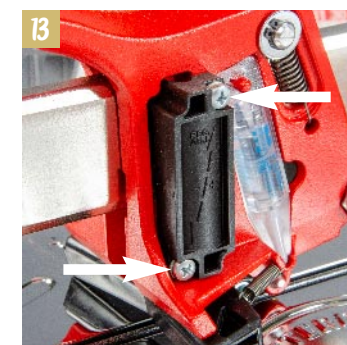
13. Dopo anni di utilizzo, se necessario, si può registrare il gioco sulla barra.
