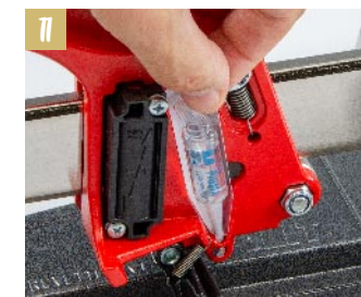
10, 11, 12. In dotazione la fiala di lubrificante per la rotella incisore, da applicare nell'apposita sede: basta una leggera pressione una tantum.
