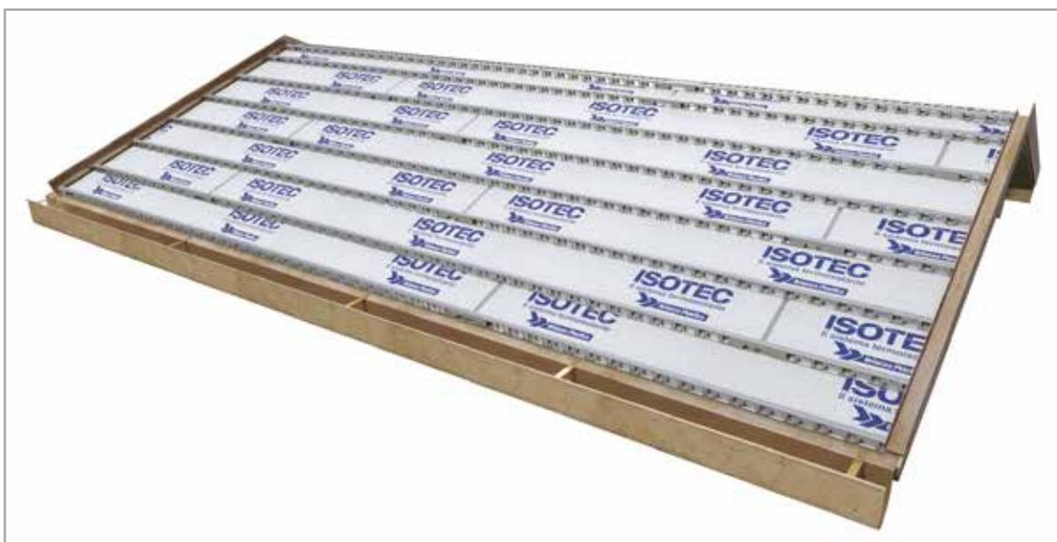
Per il taglio del pannello si procede con flessibile a disco per il correntino metallico, mentre per la parte schiumata si utilizza un segaccio a lama rigida. Una volta tagliato a misura, il pannello verrà posato e fissato.
