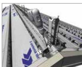
L'eventuale mancanza del correntino portategola vicino al colmo verrà compensata con un correntino Isotec apposito, da fissarsi attraverso il pannello alla struttura. Questa esecuzione assicura la continuità di supporto delle tegole di copertura.
