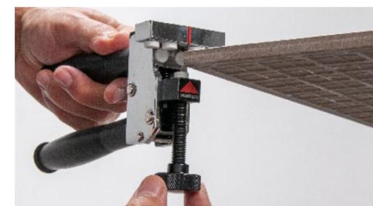
La pinza separatore ha due modalità di lavoro: per azionarla in un modo, si regola l'apertura delle ganasce sullo spessore della piastrella, si posizionano i riferimenti della pinza sulla linea di incisione, poi si agisce premendo l'impugnatura; la seconda modalità si attua posizionando correttamente la pinza sulla linea d'incisione, avvitando la manopola per portare il tampone a contatto e continuando a ruotarla sino a provocare lo spacco.
