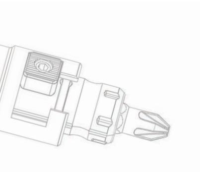
Il Flipbit consiste in un porta attrezzi doppio a cambio rapido e in un supporto che viene fissato al mandrino del trapano. Il porta attrezzi doppio è equipaggiato su entrambi i lati con utensili appropriati per una lavorazione in due fasi ed è inserito nel supporto, con il lato da utilizzare rivolto verso l' alto.
